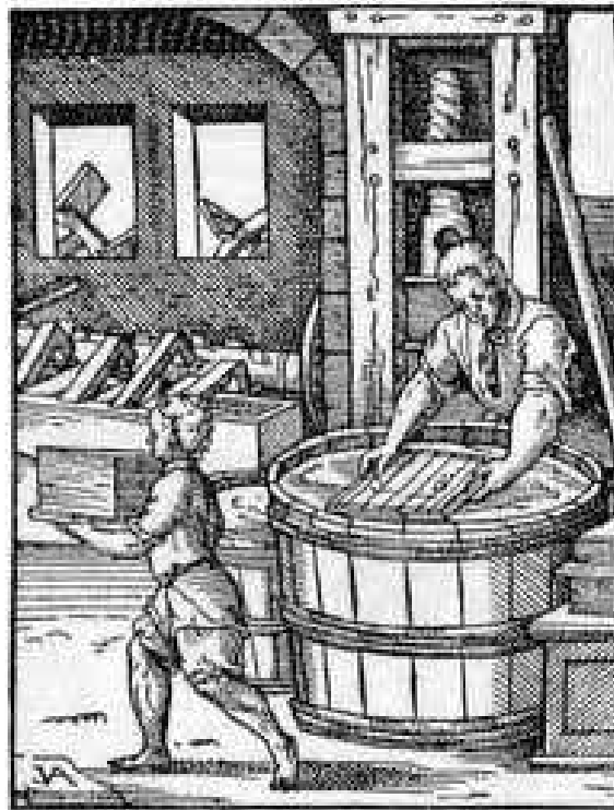
Fig. 10. La realizzazione delle forme dei fogli con la pasta di carta
